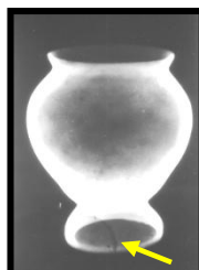
Authentification des objets d'Art : repérage des zones de restauration par Radiographie X, analyse de la composition des alliages métalliques, étude des traces d'outils sur les sculptures en pierre, etc...
